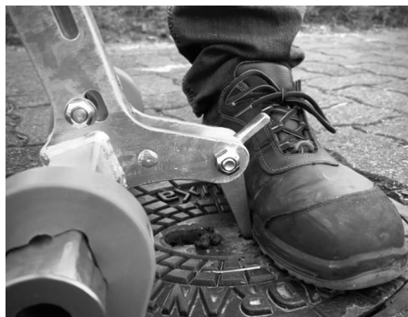
2. ... in Deckelmulde positionieren bzw. eintreten.
